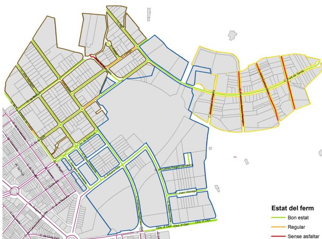
Figura 4.10. Estat del ferm del PAE Manlleu
